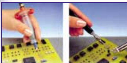
Fot. 5 Ręczny montaż elementów SMD
