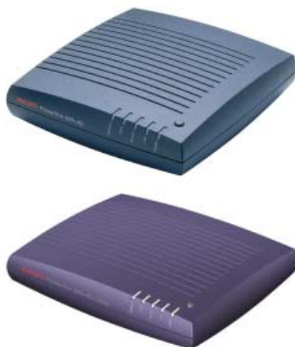
Adaptory wewnętrzne, modem użytkownika do połączenia z systemem wewnątrzbudynkowym.
