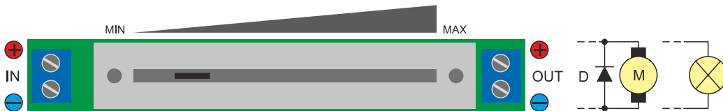
Rys. 3. Sposób dołączenia obciążenia do ściemniacza LED
