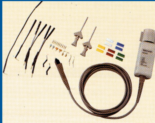
Fot. 1. Sonda czynna 1GHz (1MΩ 1pF)
