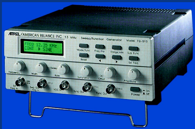
Rys. 7. Mikroprocesorowy generator funkcyjny
