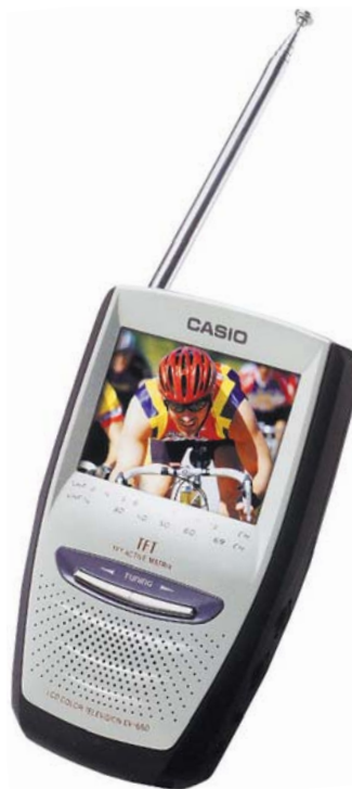
Fot. 13 Miniodbiornik TV EV-660 Casio. Wyświetlacz TFT-LCD, 7,5cm, 89856 pikseli.
