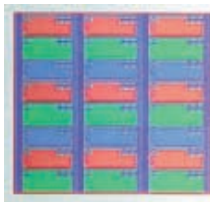
Fot. 11 Mikroskopowa fotografia wycinka ekranu TFT LCD
