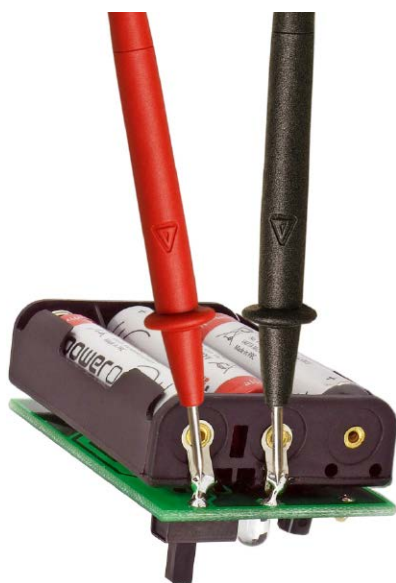
Fotografia 3. Pomiar napięcia na koszyku baterii
