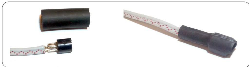
Rys. 5 Przykład zabezpieczenia czujnika za pomocą rurki termokurczliwej
