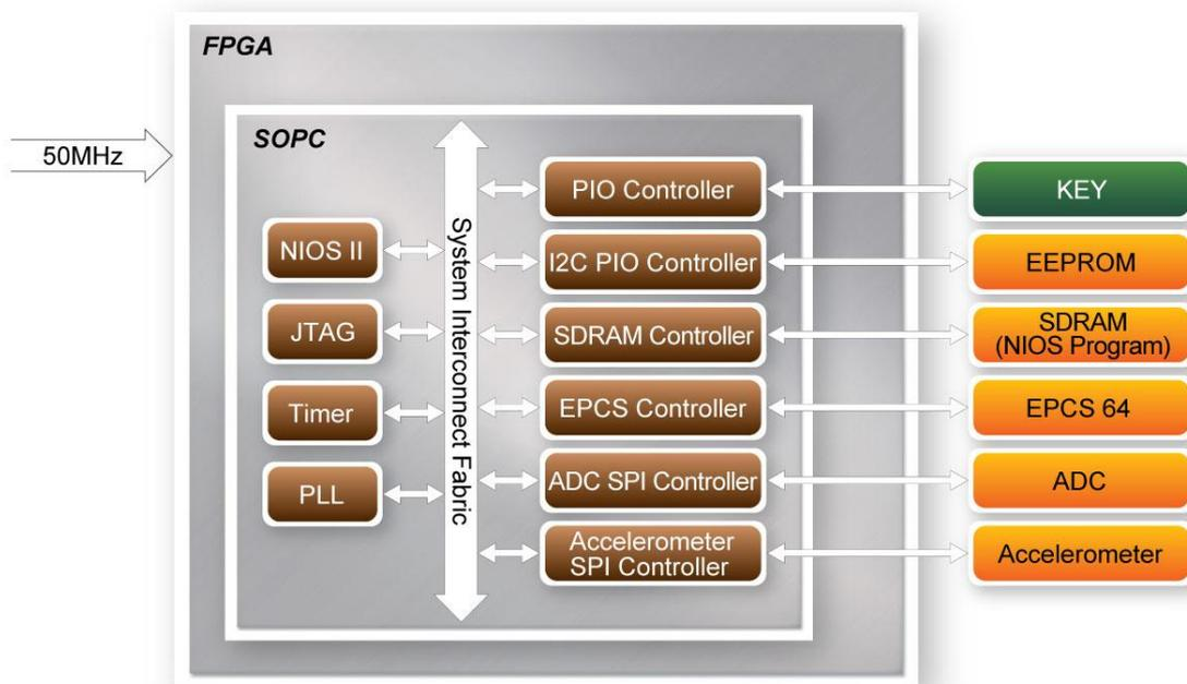
**Figure 8-6 SOPC Block Diagram**
