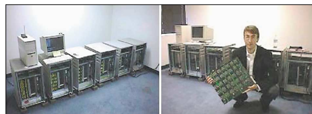
Rok 1998 Electronic Frontier Foundation Komputer Deep Crack kosztujący 220.000$ potrzebuje 4,5 dnia na złamanie jednego algorytmu DES.
