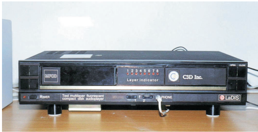
Fot. 6 Prototypowy odtwarzacz "kompaktów" FMD
