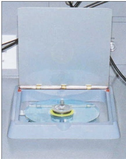
Fot. 5 Prototypowa stacja dysków FMD
